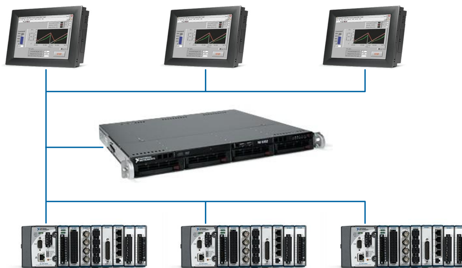
图1.3分布式机器控制系统
