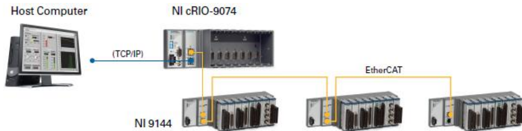
图5.7. Compact RIO硬件采用NI 9144确定性以太网机箱扩展时间先决系统
