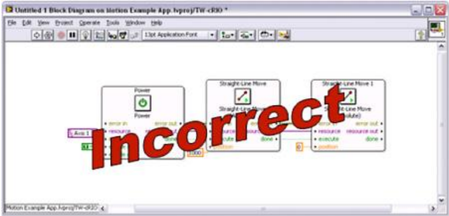
图5.37. 使用运动功能块进行运动编程的错误实例
