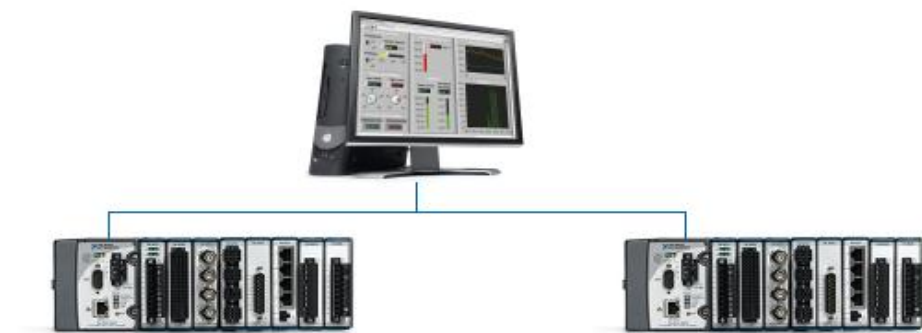
图 5.1. 添加另一Compact RIO系统作为以太网I/O的最简单方法，是将两个Compact RIO系统连接至相同网络
