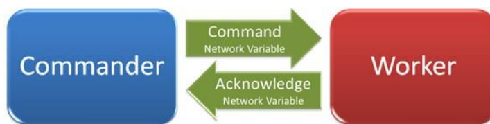
图 4.32 使用网络变量的简单的公认命令结构
