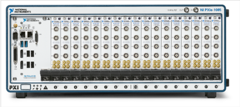
图8. 在单个PXI机箱（19英寸4U机 架）中组合多达68 个或136个示波器 通道，实现高速采集 系统
