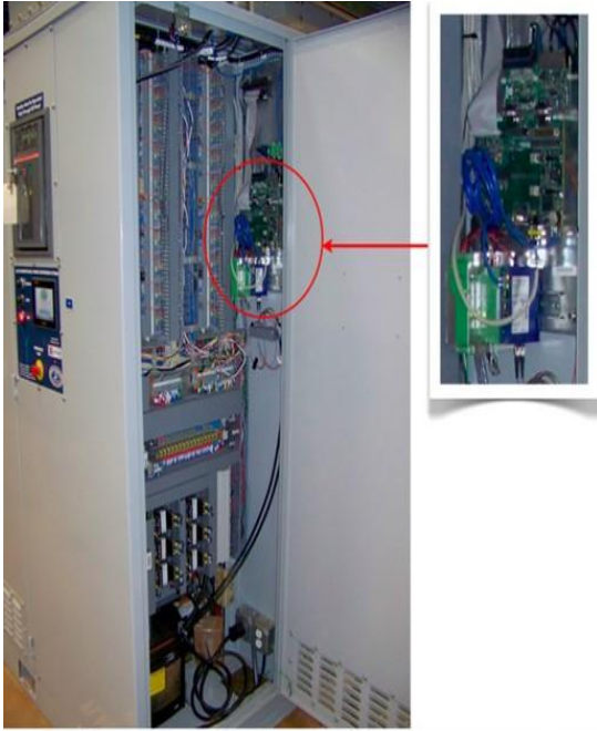
图 1: 逆变器机箱内配备嵌入式 NI Single-Board RIO,
