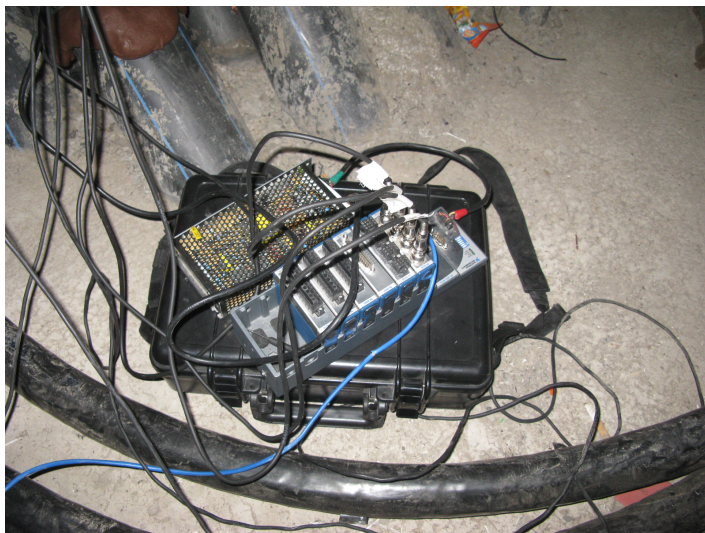
图 14 CompactRIO 数据采集平台
