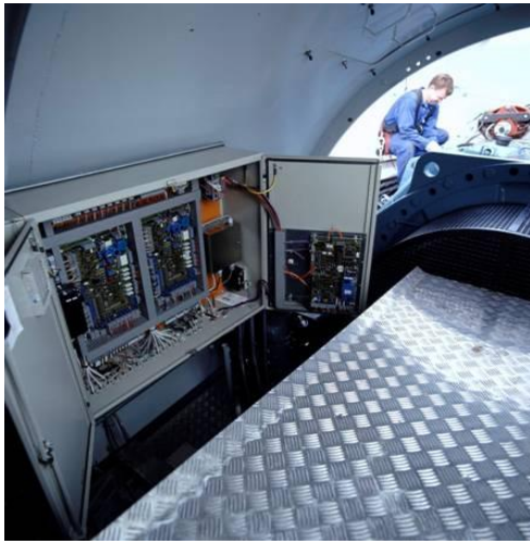
图 2 kk 电子风力涡轮发电机控制系统
