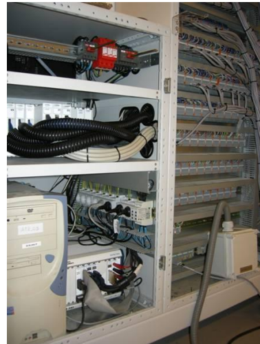
图 3 以 NI PXI 与 SCXI 硬件为基础的 kk 电子测试系统
