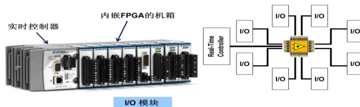
图 1. NI CompactRIO 的硬件架构
