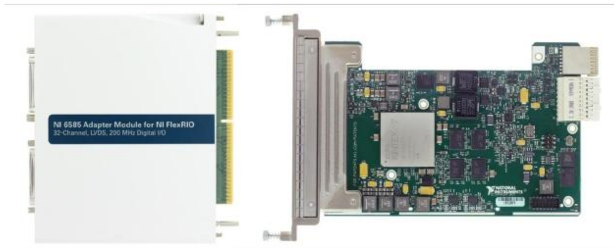
图3. NI FlexRIO设备包含了大型FPGA，可以直接连接适配器模块，提供多种I/O选项。
