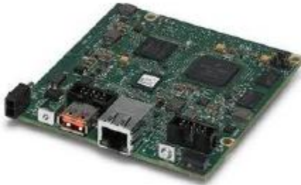
图8. NI Single-Board RIO使嵌入式RIO平台具有更小的外形尺寸，适用于部署应用。
