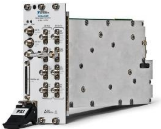
图5. 矢量信号收发仪(VST)结合了仪器级的矢量信号发生器和采集器到一台包含大型FPGA的3槽PXI组成结构中，FPGA可以用使用LabVIEW进行自定义。
