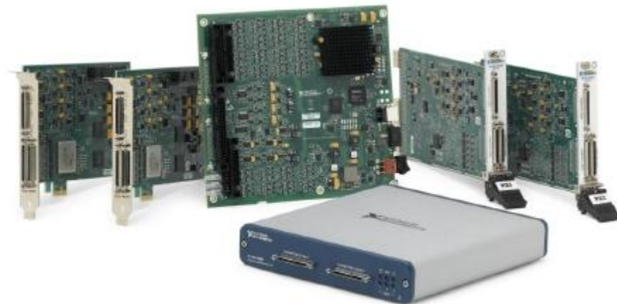
图4. NI R系列多功能RIO设备通过可使用LabVIEW编程的FPGA扩展了通用多功能DAQ。
