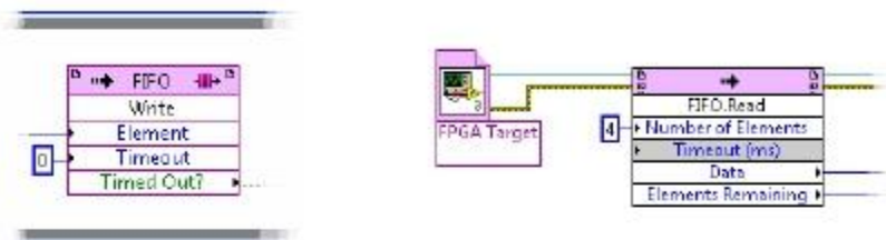
图96. 主机接口FIFO不考虑FPGA和主机系统之间DMA通信的复杂性。此范例展示您如何从FPGA端一次写入一个元素，并从主机端一次读多个元素。
