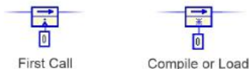
图75. 由于反馈节点集可以通过Compile or Load初始化，您可以使用更少的资源实现更快的编译速度。
