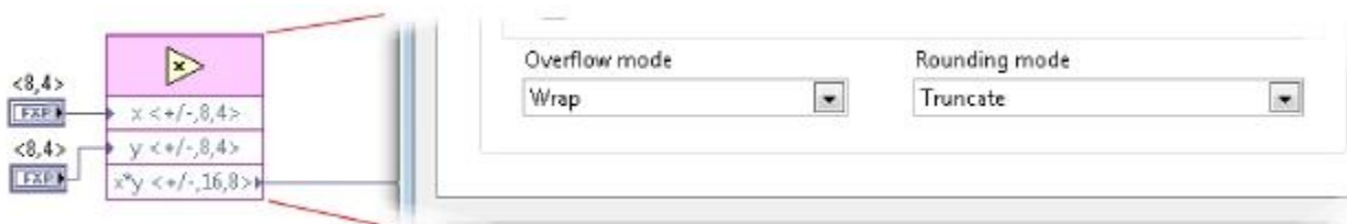
图74. 当您指定高吞吐量数学函数的输出类型时，它们默认处于Wrap溢出模式和Truncate舍入模式，以保证性能和资源效率。
