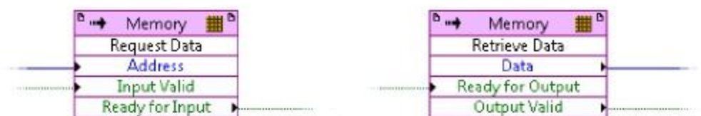
图93. 读取DRAM是在Retrieve Data方法的Output Valid信号为真时通过给定地址请求数据，然后在几个周期后对其进行检索来实现。
