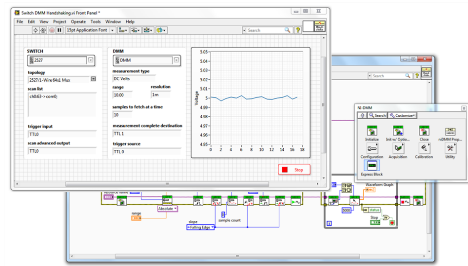
图7. 该程序示例显示了如何将NI- SWITCH和 NI-DMM驱动程序结合。
