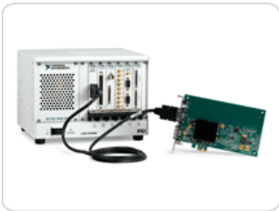
图 6. 通过MXI- Express远程 控制套件实现PC机 对PXI的控制
