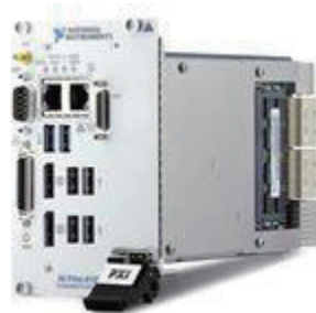
图11. 例如，NI PXIe-8135控制器搭载了Intel Core i7-3610QE处理器，具有高达16 GB的DDR3 RAM、硬盘驱动器以及ExpressCard、USB2.0、USB3.0、以太网、串口、并口和GPIB端口等标准PC外设接口。
