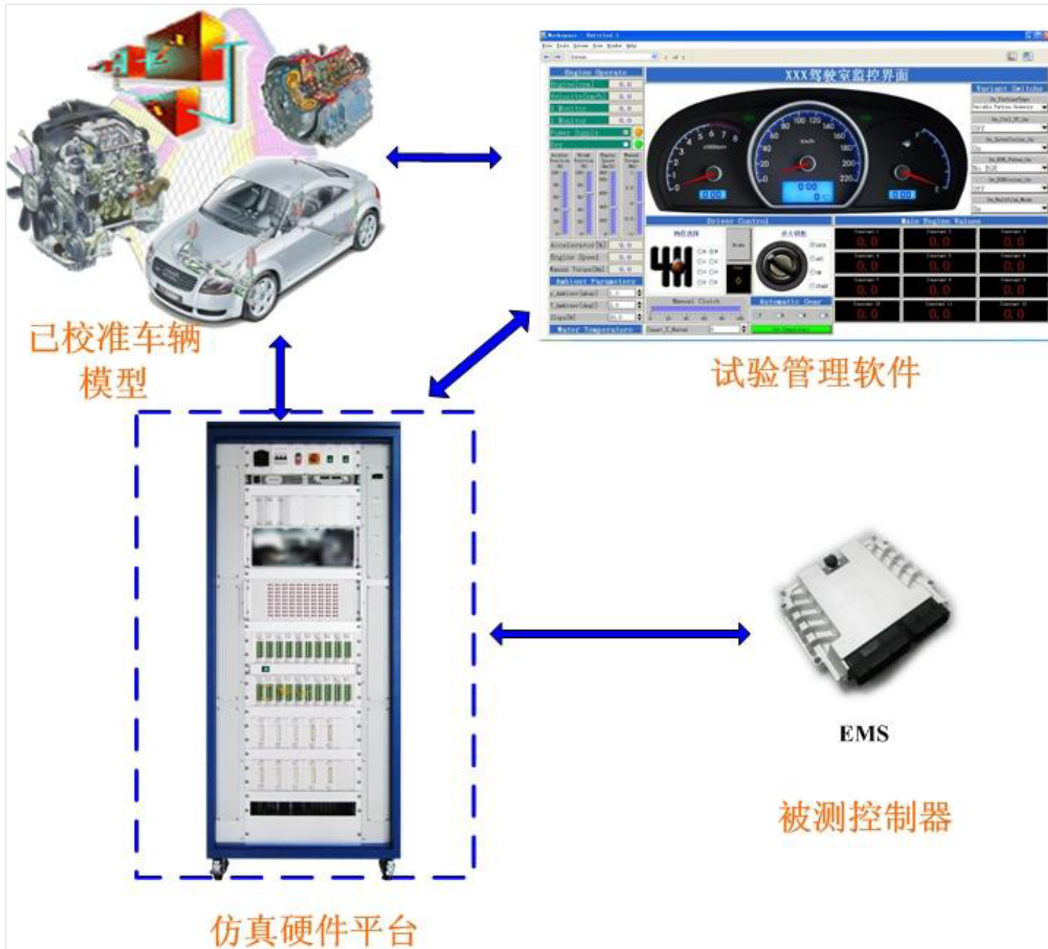
图2.1 EMS HIL测试系统结构图
