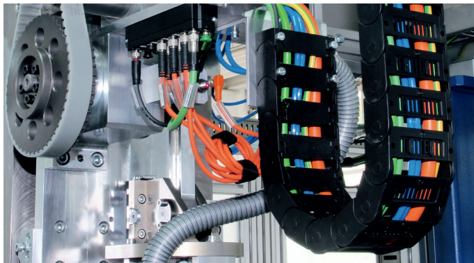
紧凑型设计通过驱动技术 — 这里是一台 AM3000 伺服电机 — 和用于直接采集分布式工艺数据的 EP 系列 IP 67 I/O 端子盒（图片中间）实现
