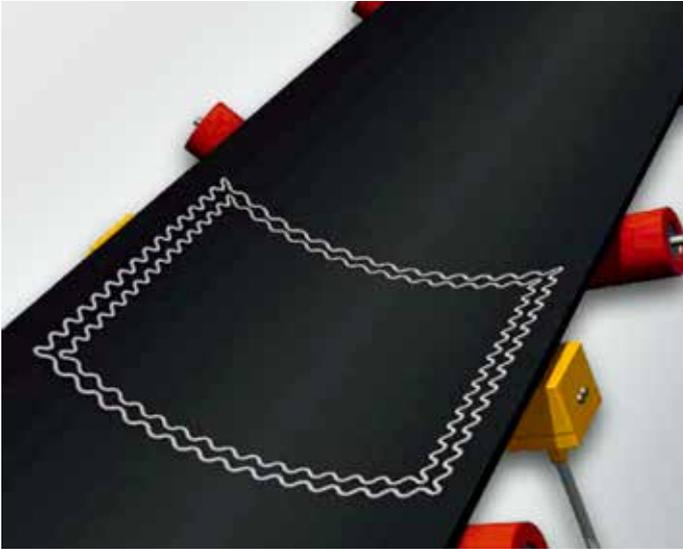
发射装置与配备有 BRD 的输送带中的导体回路
