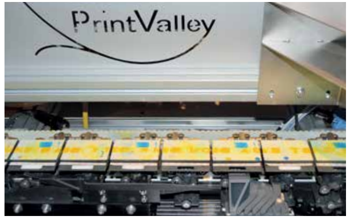
可升降输送带用于快速调整托盘高度
