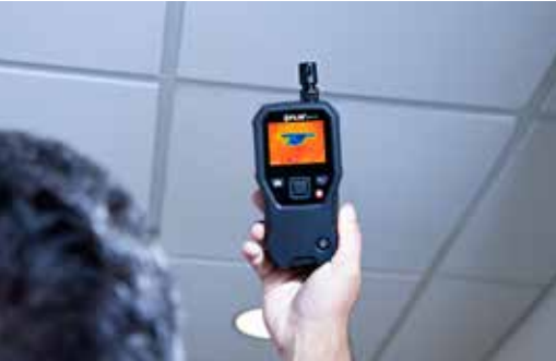
IGM红外成像引导测量技术引导用户发现湿气问题点
