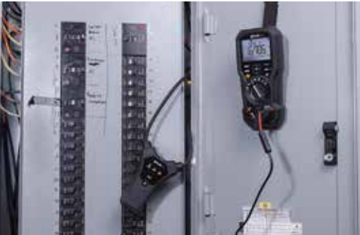
FLIR TA74和FLIR DM93万用表配合使用
