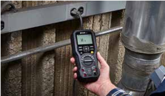
借助内置的非接触式电压笔(NCV)检查是否存在电压
