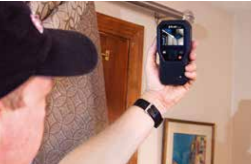
FLIR MR160正在探测天花板和墙角缝隙的受潮情况
