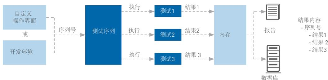
图4. 测试执行软件在测试系统的一部分作用是整合执行过程中生成的结果，并生成报告发送给数据库。
