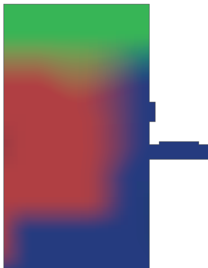
图4. 局部热区或导致整个测试机架的不同位置具有不同的温度。
