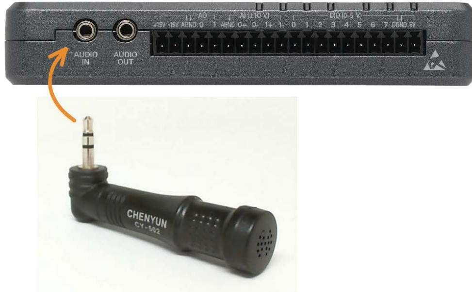
图 10.2: 直接连接 AUDIO IN 的驻极体麦克风演示电路。
