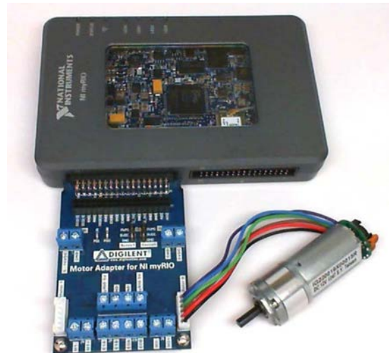
图 18.1: NI myRIO 机电一体化附件包附带的电机适配器和减速电机。
