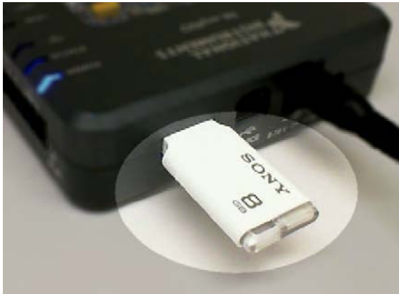
图 36.1：插入了 USB 闪存驱动器的 NI myRIO USB 连接器。
