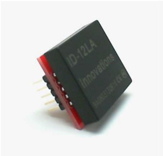
图 39.2: 焊接后的 RFID 读取器、分线板和接头。
