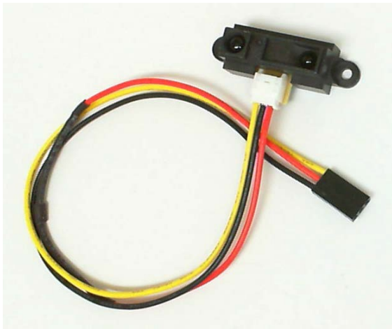
图 19.1: NI myRIO 机电一体化附件包附带的红外测距仪。
