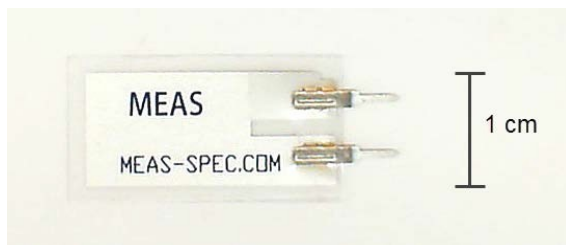
图 16.1: NI myRIO 起步附件包压电效应传感器。
