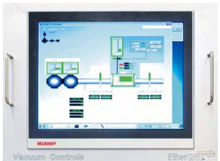
由 LIGO 开发的真空控制系统大量运用基于 PC 的控制系统和 EtherCAT 通讯技术
