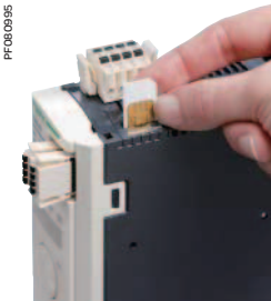
VW3A8126 存储卡复制参数
