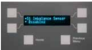
数字显示屏-三相不平衡检测设置
