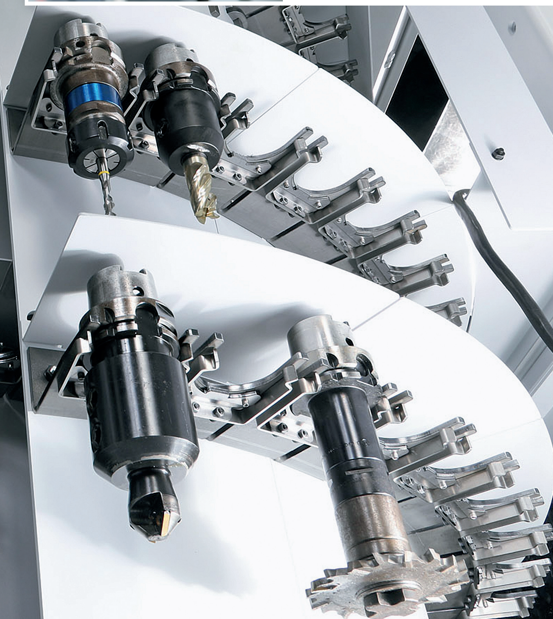
Wassermann 的这款刀具终端集成了三个同心刀鼓，因此结构非常紧凑
