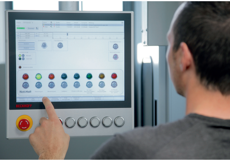
倍福的 CP3915 多点触控控制面板采用现代化设计，具有按钮扩展件，可为刀库提供高品质外观
