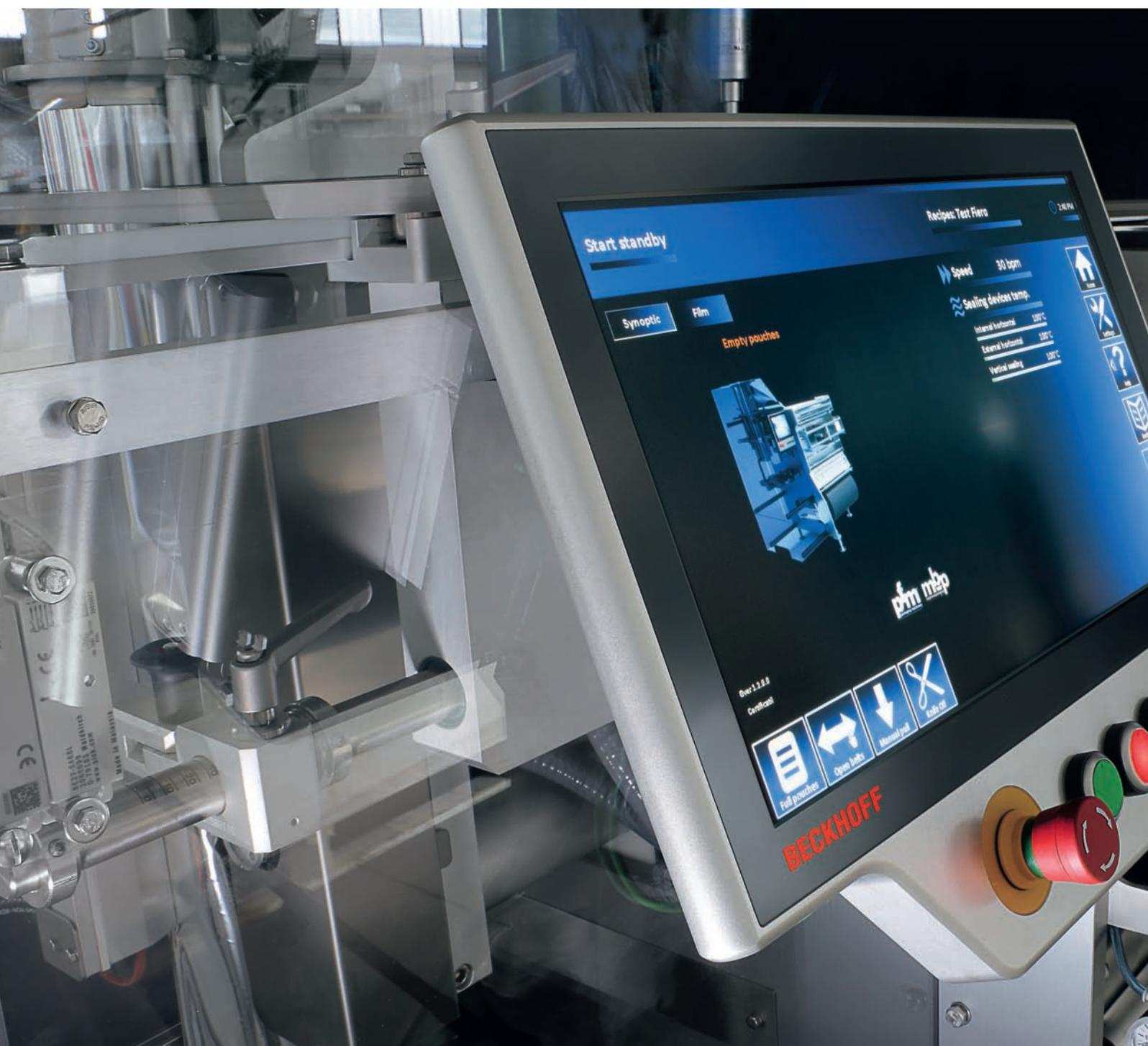
在 2017 年举行的德国国际包装展 Interpack 上，意大利包装机械制造商 PFM Packaging Machinery S.p.A. 公司的子公司 MBP 公司展出了其革命性的开发成果。他们的立式灌装封口一体机将连续运行机器中常见的高速处理能力与间歇运行解决方案的快速、灵活的规格修改能力完美结合于一体。该款机器的全新设计基于倍福的 PC 控制和自动化架构，充分利用了该架构的高性能。
