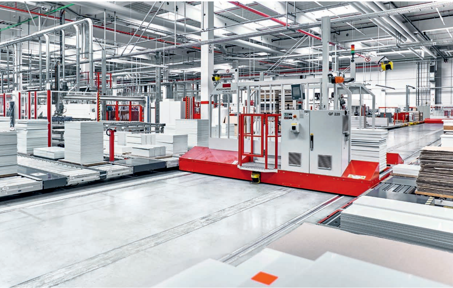
不同的横向输送车以每分钟 85 米的速度行进，不会危及来往的工人和叉车安全
