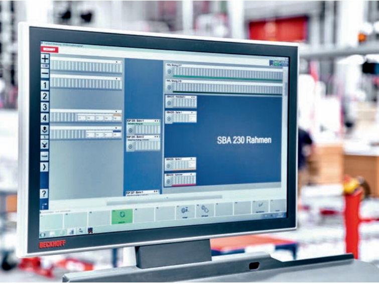
可视化系统真实再现了带有辊子输送机 and 横向输送车的运输区域；多点触控功能可以轻松实现放大缩小，在详细信息显示和概览之间进行切换
