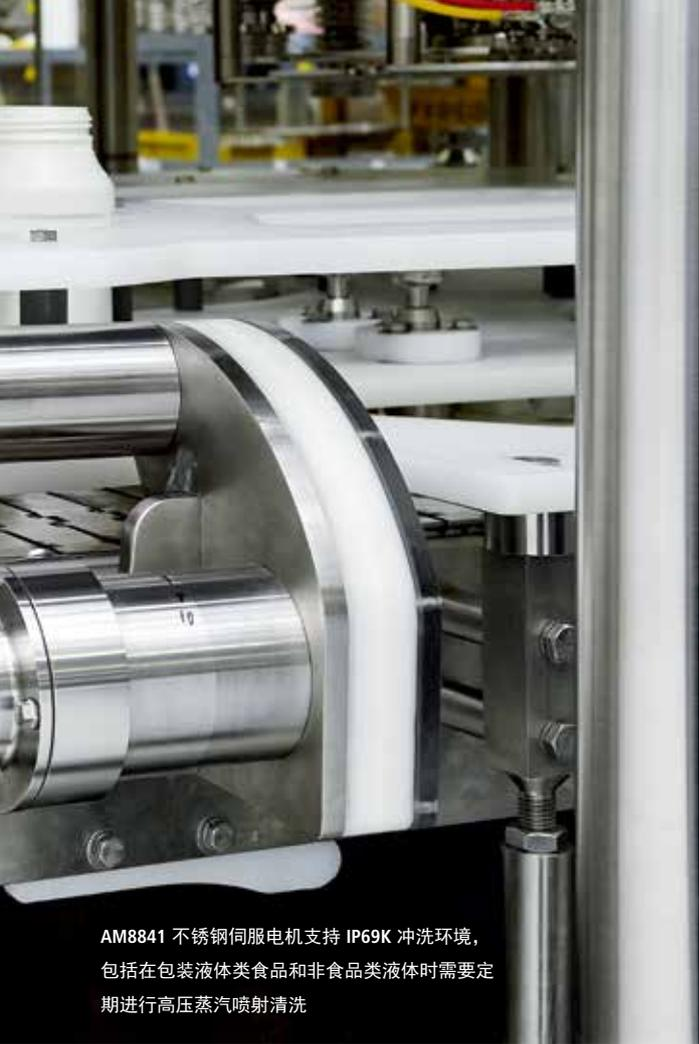
AM8841 不锈钢伺服电机支持 IP69K 冲洗环境，包括在包装液体类食品和非食品类液体时需要定期进行高压蒸汽喷射清洗
