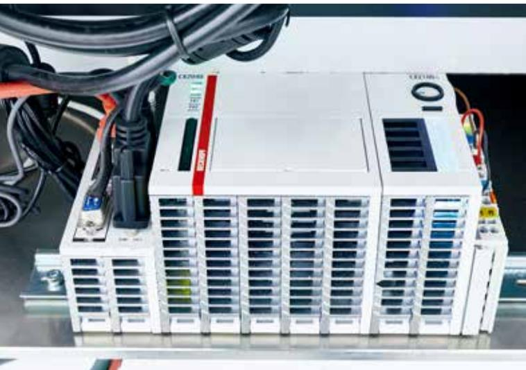
一台运行有 TwinCAT NC I 的 CX2040 嵌入式控制器用来控制大面铣床
