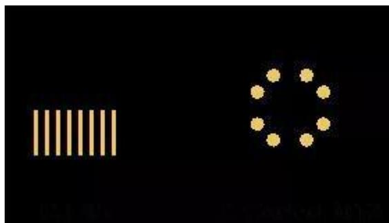
图 5. 普及广的 RJ45 连接器 (左) 和更不常见的 X-Coded M12 连接器 (右)
