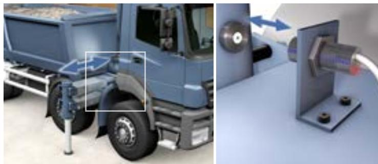
磁式接近开关能够检测 60 mm 以内的磁场, 甚至能够透过不锈钢等非铁磁性材料进行检测。即使是潮湿或多尘环境, 磁式接近开关仍然能够精确、可靠地触发开关动作。接近开关的感应范围取决于所选永磁体, 因此拥有多种安装方案, 甚至能够安装在狭窄空间内。永磁体在固定时无需考虑极性, 且允许较大的安装误差, 从而节省安装时间和工作量。
