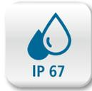
IP 67 包含了 IP 65 防护等级。另外，对于此防护等级，当外壳在规定的压力和时间条件下（1 米水深，30 分钟）浸没水中，传感器仍能防水。
