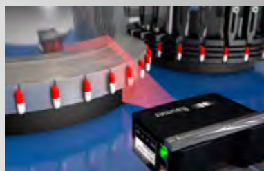
检查和分选：胶囊变形检查
