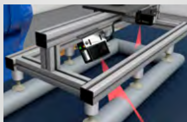
中心位置测量 (确保真空吊具牢固吸附)
