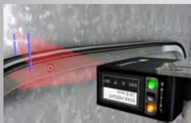
测量橡胶密封件的最大高度
