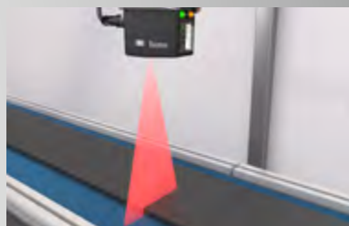
测量橡胶胎面的高度
