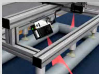
PosCon CM——测量圆形物体
