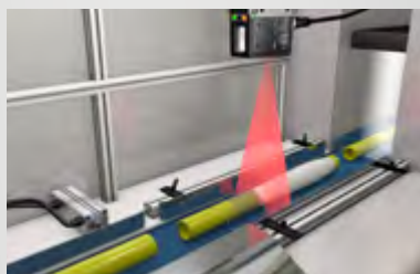
测量纱管直径以确定纱线余量
