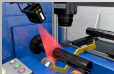
精确测量中心位置 (确保可靠的表面检测)
