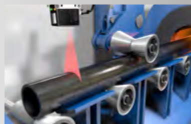
测量钢管直径
