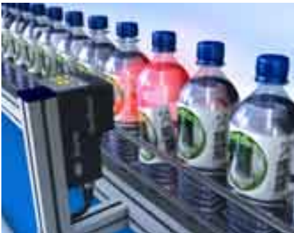
瓶子及酸奶杯的标签、封盖和盖子检查
