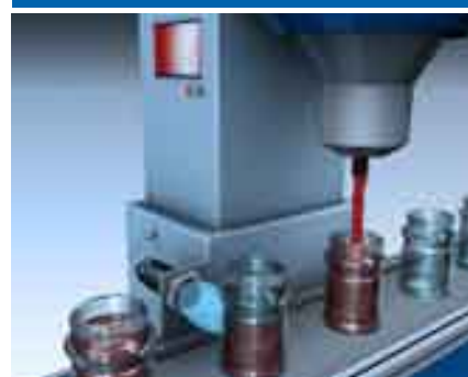
透过包装材料的非接触式物位监测
