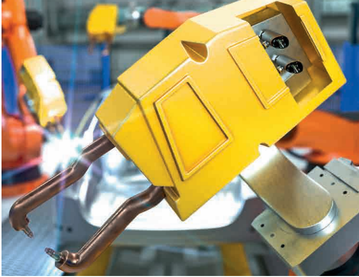
双重保护： FS+不仅监测焊接 机器人的冷却剂流 量，还可监测任何 即将发生的冷却回 路过热问题
