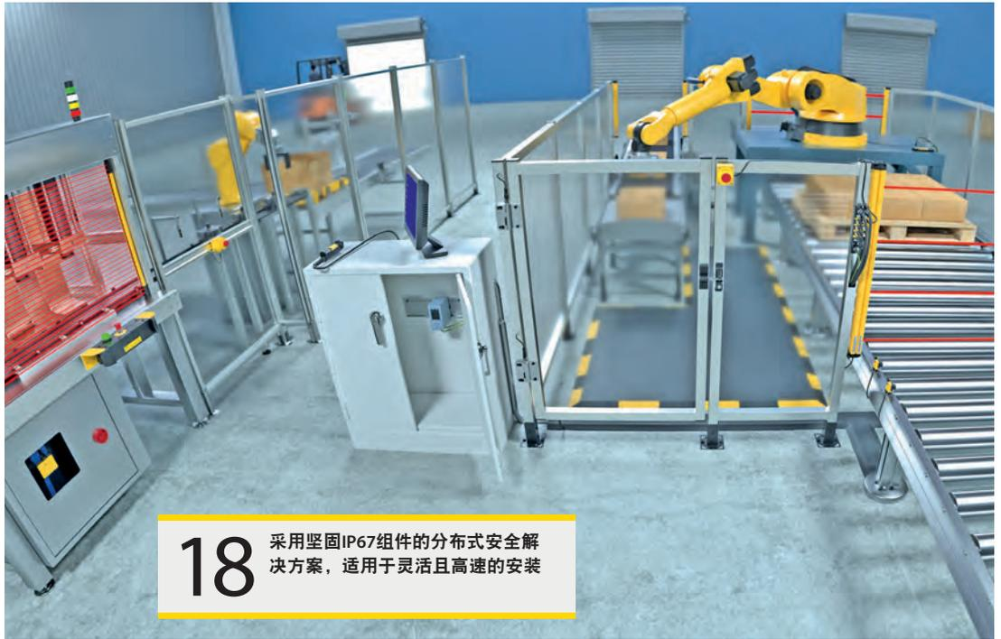
**18** 采用坚固IP67组件的分布式安全解决方案，适用于灵活且高速的安装
