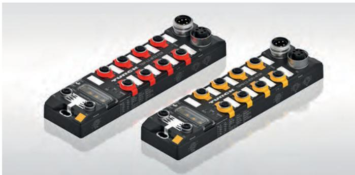
图尔克支持Profisafe或CIP Safety的TBPN和TBIP坚固型故障安全IP67 block I/O模块，可直接从现场为安全控制器提供安全输入和输出信号。这些模块也可在现场作为分布式安全控制器来使用，可以解决现场到中央控制器的信号传输距离较长，而导致的较大总线通讯循环时间的问题。全新的block I/O设备可在现场提供4路安全输入信号 (FDI) 和4路通用输入或输出信号 (FDX)。凭借FDX通道的高灵活性，该产品能够实现对各种故障安全应用中不同的信号类型的需求。这些模块的安全等级可达PL e、4类、及SILCL 3。每路输出可为执行器提供2 A电流，总共可提供9 A电流。
