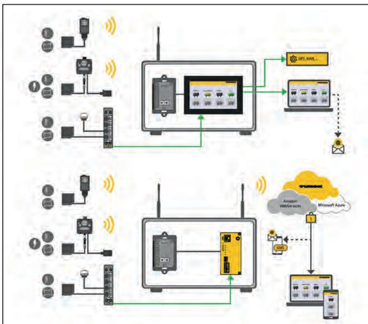
图尔克的云服务可托管在客户的内部服务器，或作为中央数据中心的公有云，通过加密协议来处理通信
