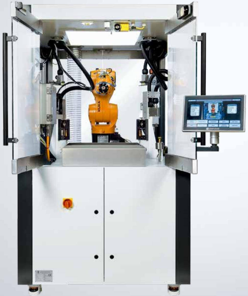
交钥匙、完全自动化的 PTU1200 等离子工作站执行完整的等离子处理工艺，能够适应任何市售的注塑机
