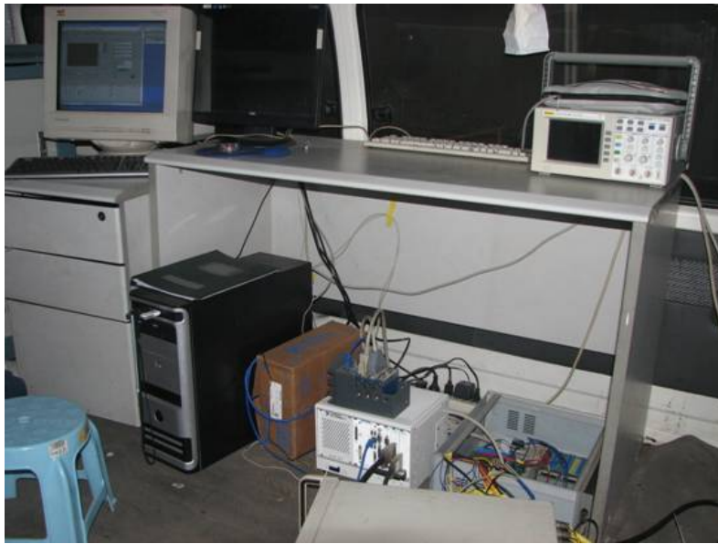
图4 上位机、下位机及控制器
