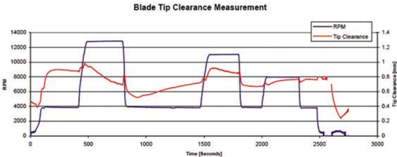
图4. 3个快速 加速、减速循环中，叶尖间隙随引擎速度 变化而振动
