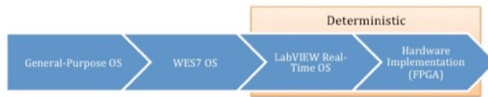
图1. 与一般的操作系统相比, LabVIEW Real-Time 和 WES7 提供了更高的可靠性
