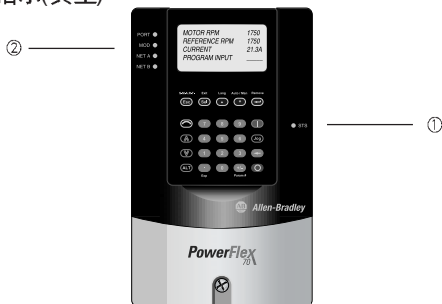
图2.1 变频器状态指示(典型)
