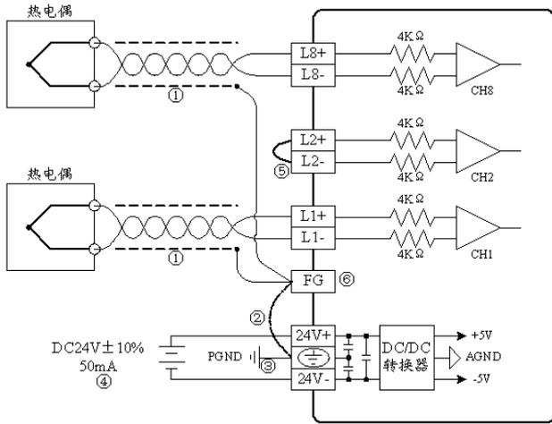
图 2-5 MC200-8TC 用户端子布线示意图
