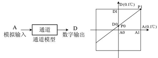
图 4-1 MC200-8TC 的通道特性示意图
