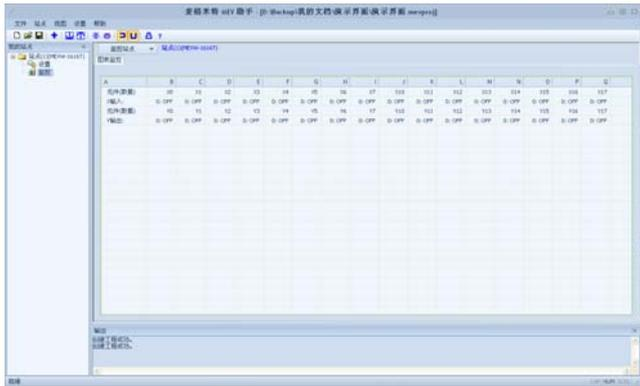
可以通过调试助手来设置和监控远程 IO 的输入、输出状态及其他参数。
