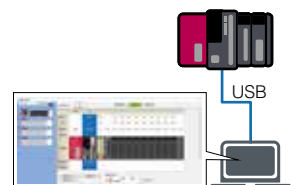
USB连接后自动开始诊断
