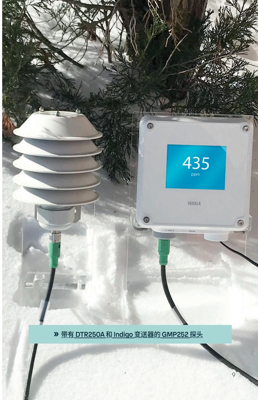
» 带有 DTR250A 和 Indigo 变送器的 GMP252 探头
