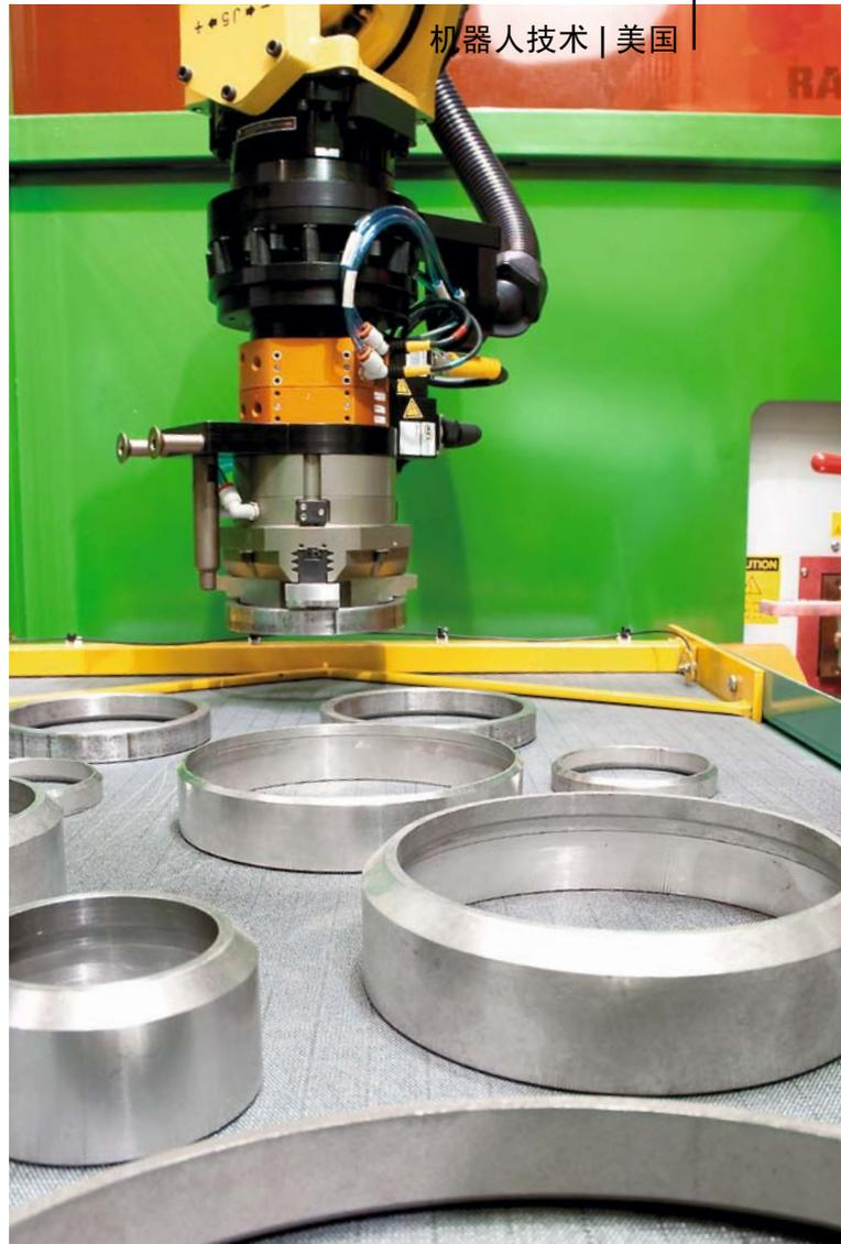
机器人从一个进料输送带拾取一个端环
