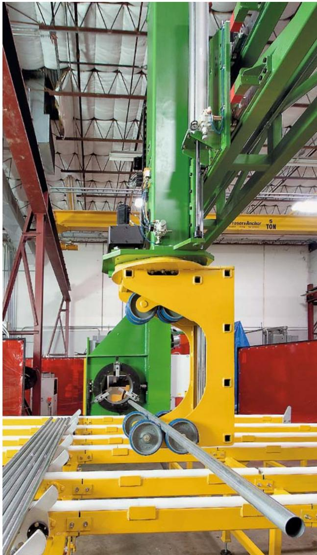
定尺气缸（长 121 到 304 cm，直径为 4...20 英寸）由一台龙门起重机拾取并放到伺服驱动固定卡爪中
