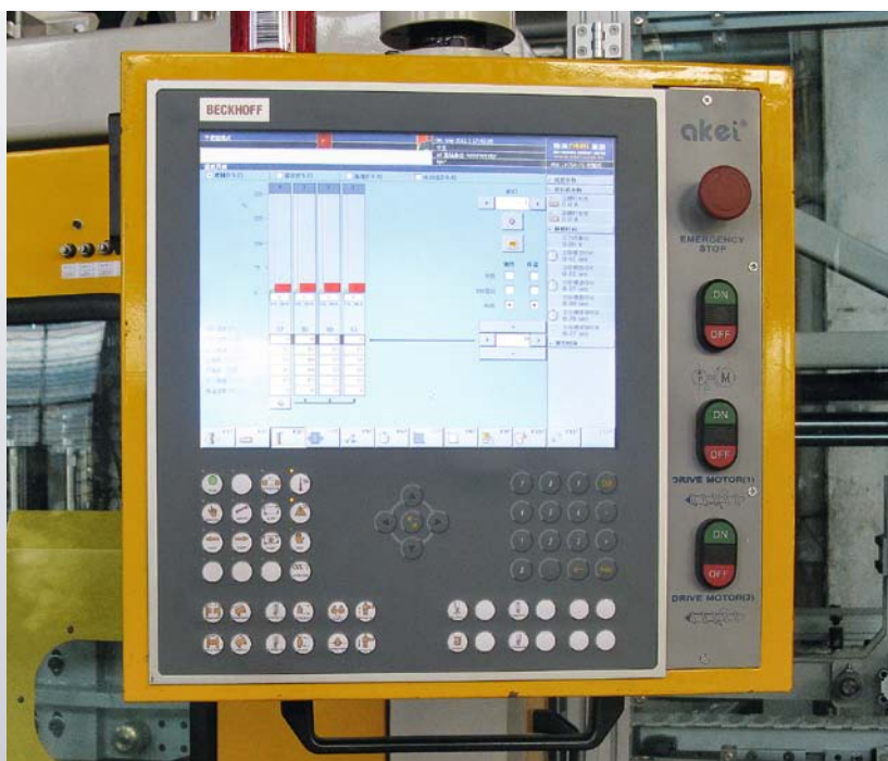
Beckhoff 吹塑机面板型 PC CP6202-1026-0010 提供操作一个高级吹塑机所需的所有功能
