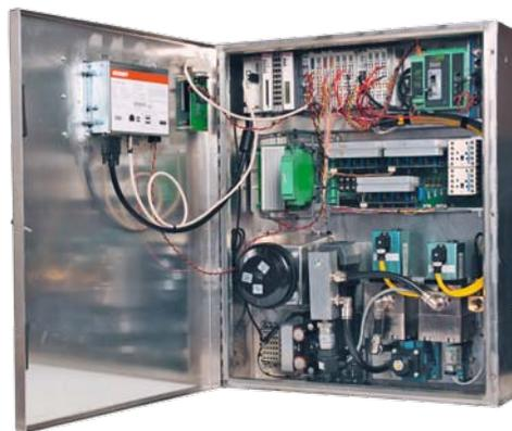
Triad 控制平台由一台 Beckhoff CX1010 嵌入式控制器、可直接连接的 EtherCAT I/O、TwinCAT PLC 自动化软件和一台带 5.7 英寸显示器的 CP6907 控制面板组成
