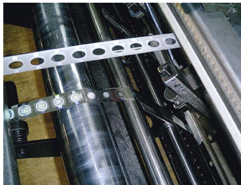
高速、精确地记录电化铝色标位置。然后通过 EtherCAT 增量编码器接口端子模块传输给控制器
