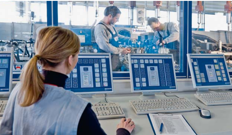
在控制室——耐久性试验设备的核心所在——内，所有来自测试过程的测量值都以高速和可视化的方式记录
