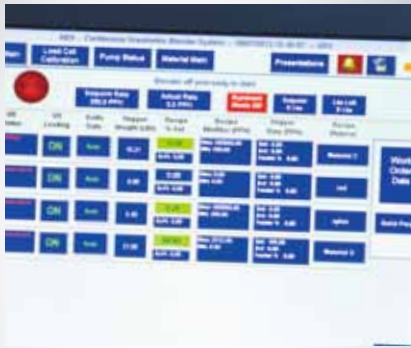
带触摸屏功能的 15 英寸 CP6202 嵌入式面板型 PC 实现了塑料计量和混合机器的便捷操作。
