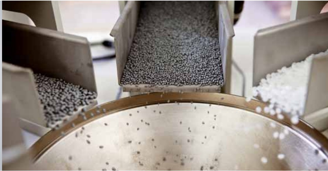
在持续生产理想的混合物的同时，ABS 开发的连续混合机能够同时计量所有成分，省去了机械混合的需要。
