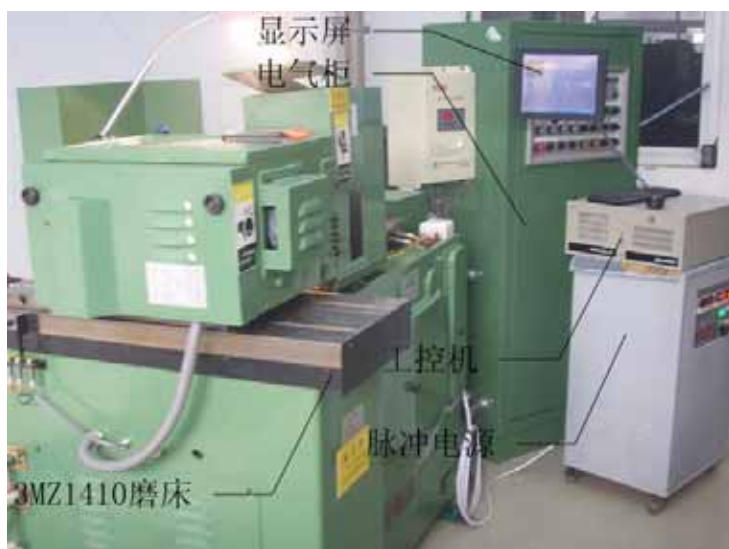
图 3 改造后的数控磨床
