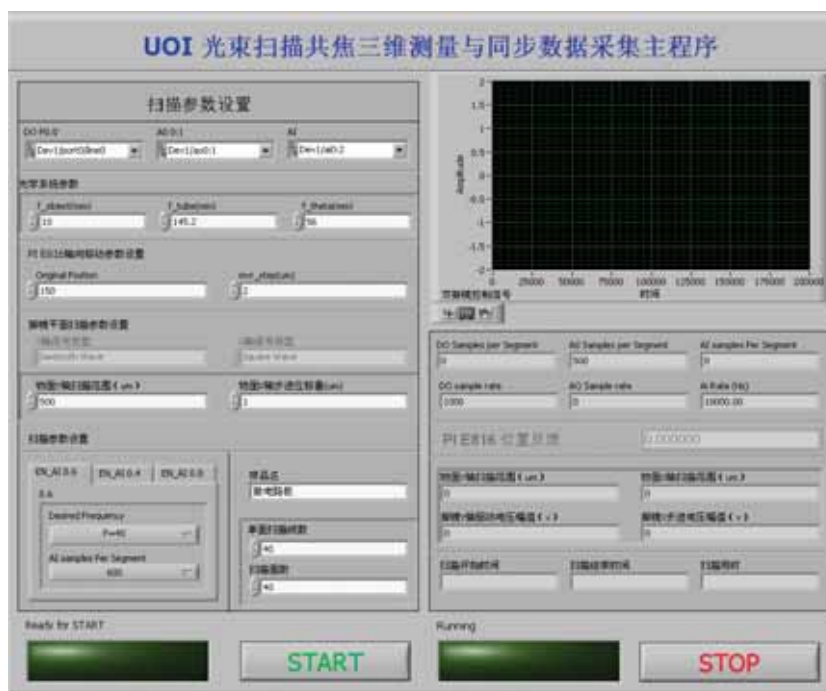
图 9 光束扫描共焦三维测量与同步采样主程序前面版界面
