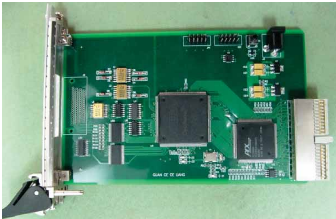
图 A 惯测测量板卡实物图
