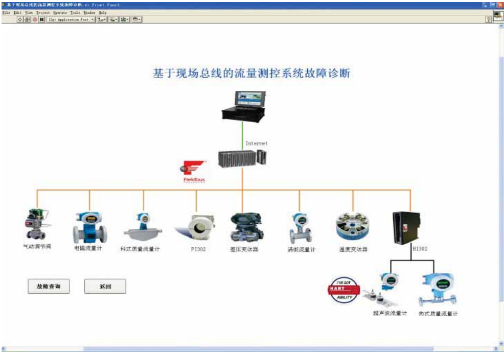
图 8 现场总线流量测控系统故障诊断主界面
