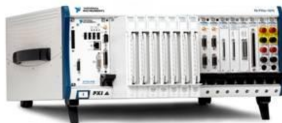
图 2. PXI 结构测试系统实例
