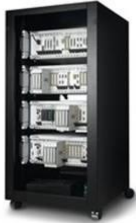
图 3. 大通道数多机箱 PXI 系统
