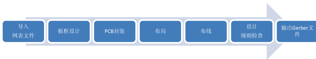
图 4 使用 Ultiboard 设计 mySensor PCB 的工作流程
