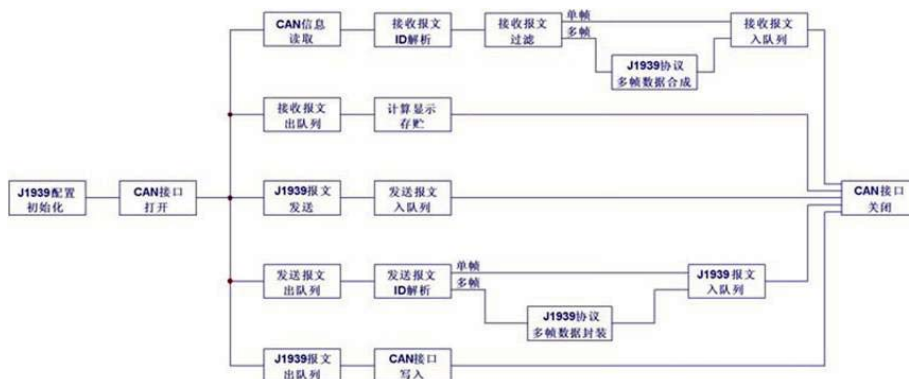
图3 基于LabVIEW 和J1939 协议的CAN 总线通讯报文收发多任务处理
