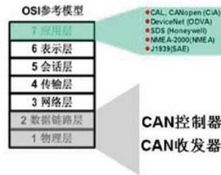
图2 开放式系统互联参考模型（OSI）
