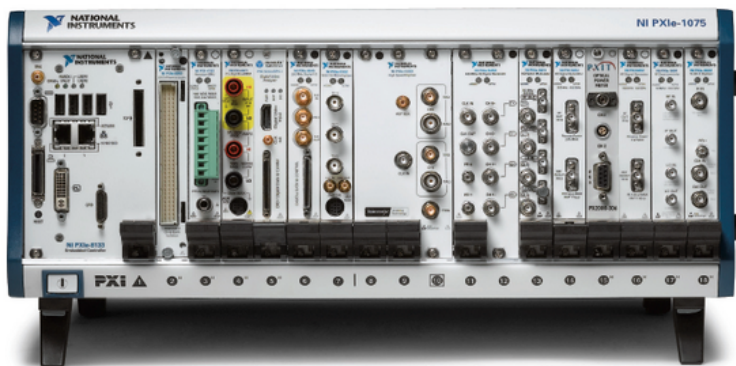
图1.此NI PXIe-1075系统所展示的几位PXI自动化测试系统的典型范例，具有VSG、SMU、DSA以及所需的开关模块。
