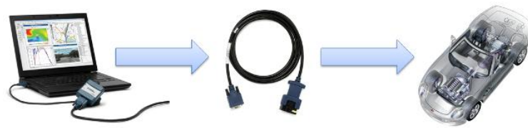
图3. 使用汽车诊断命令集在你的笔记本电脑上开发一个应用程序来掌控你自己的汽车，将你的笔记本电脑和NI CAN接口相连，然后直接用电缆将CAN接口和汽车上的OBD- II接口相连。
