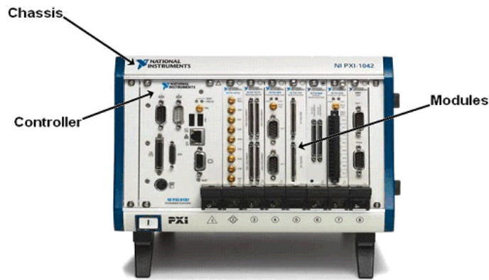
图5. PXI平台由机箱、控制器和I/O模块组成。
