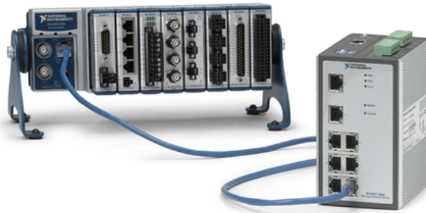
图6. 以太网数据采集支持范围达到每段100米，并且能够使用现有的网络基础设施，延展了测量系统的覆盖范围。
