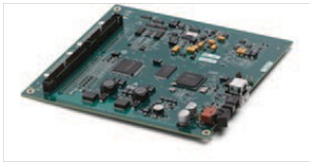
图1：最新的可用作 OEM应用的 USB X系列设备 提供了单块板卡的选 择，可嵌入设计于较 大的测控系统中
