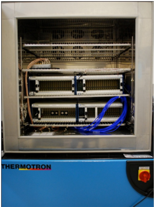
图4. 美国国家仪器进行燃烧和温度调节测试时的温度测试箱
