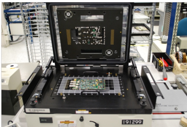
图2. 在线测试，“针床”，测试站
